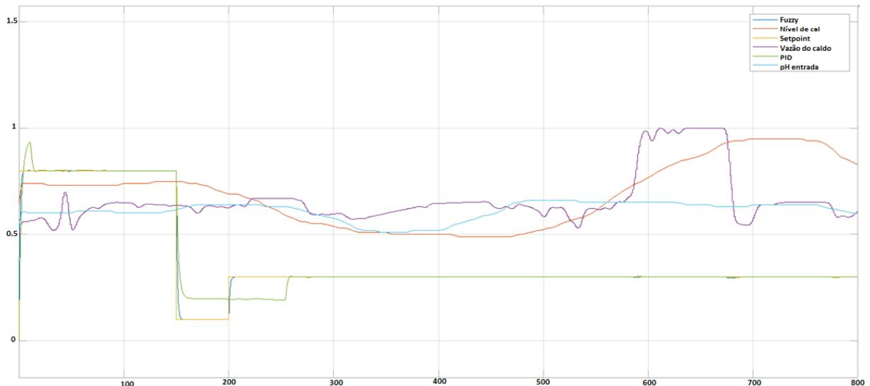
Figura 30 – Resposta ao degrau e as variações no pH, nível do cal e vazão do caldo.
