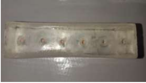
Figura 7 – Canais artificiais após a remoção de material obturador presente no topo dos canais
