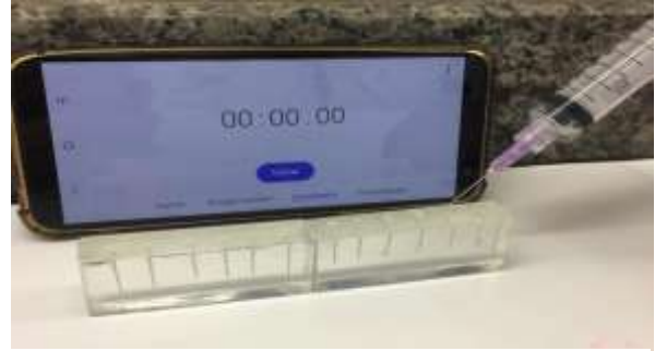
Figura 8 – Colocação dos solventes nos canais artificiais e cronometragem do tempo
