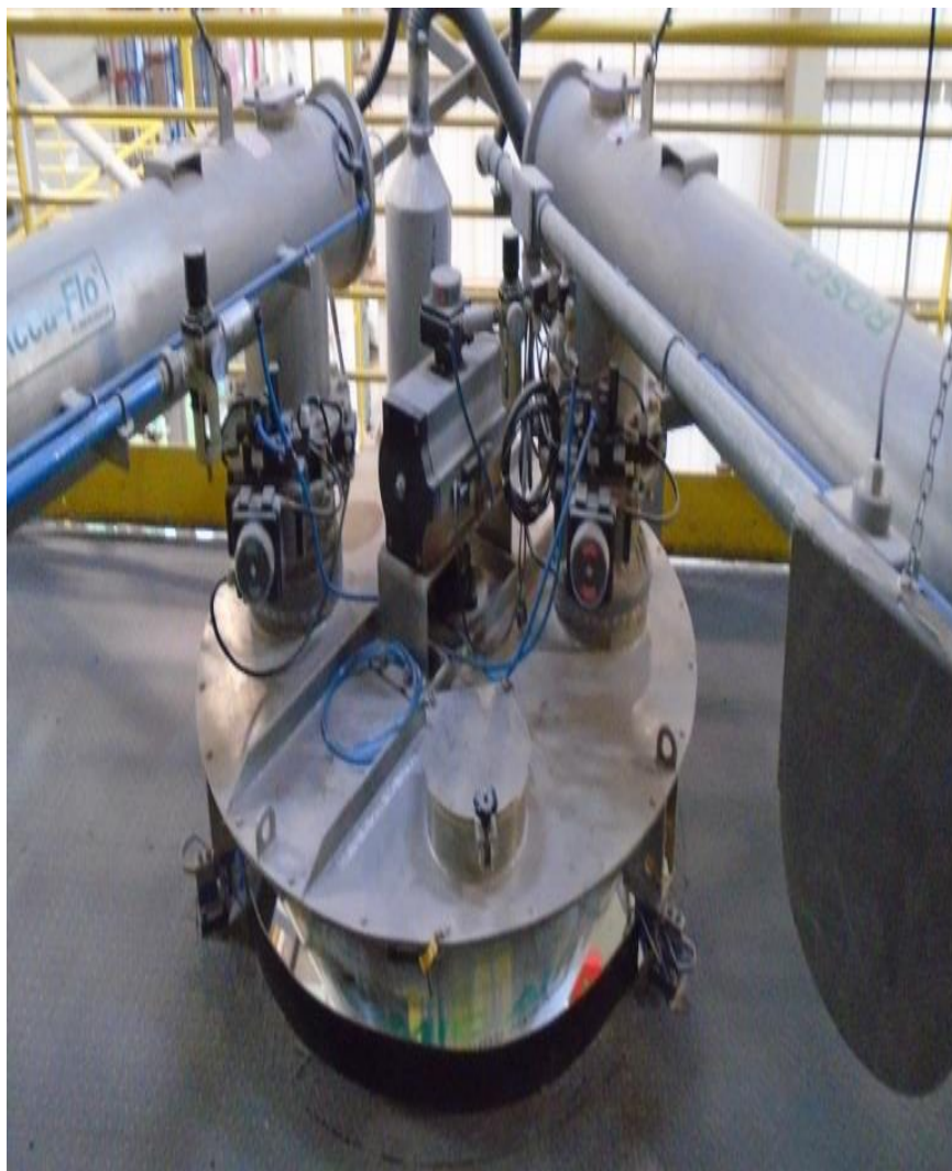
Figura 4.8 - Visão superior Roscas dosadoras de pós para extrusão automatizadas. (Autor, 2020)
