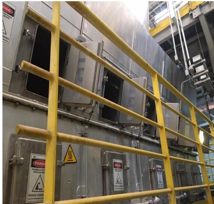
Figura 4.19 - Leito fluidizado industrial constituído por multi-câmaras, portas laterais de inspeção acesso.(Autor, 2020).
