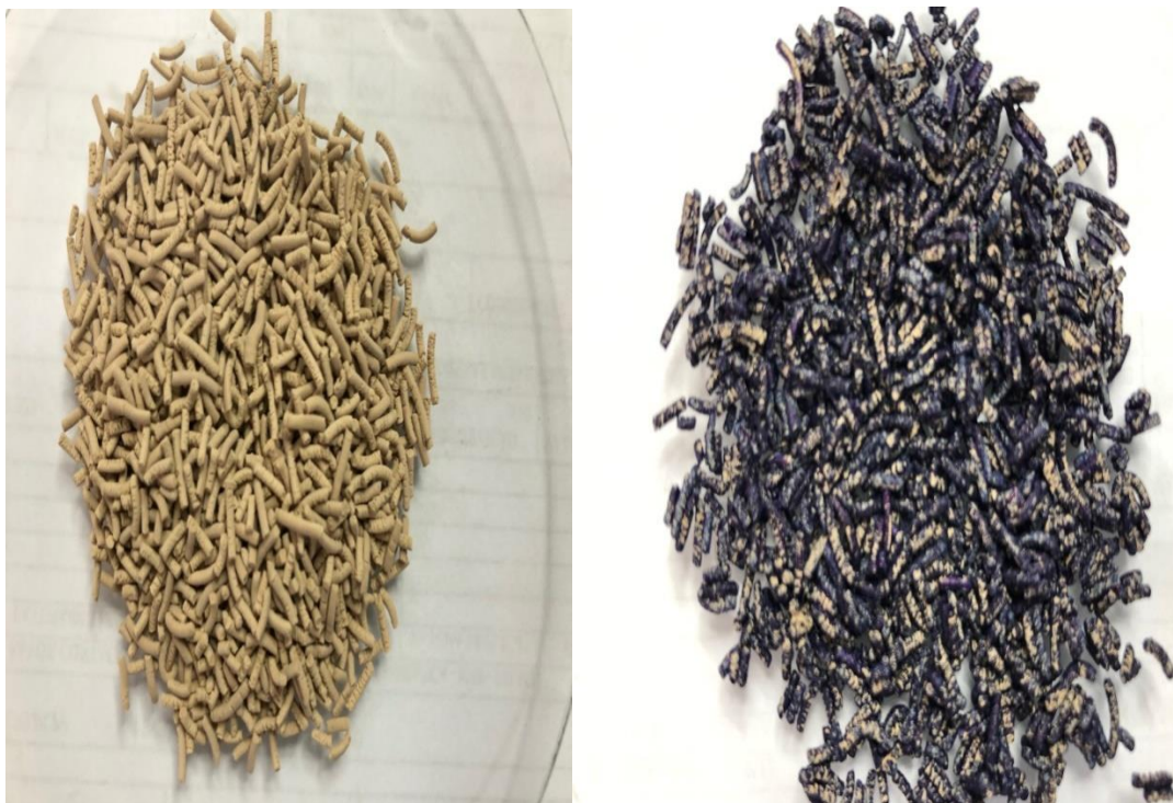
Figura 5.5 - Pintura dos grânulos para identificação. (Autor, 2020).
