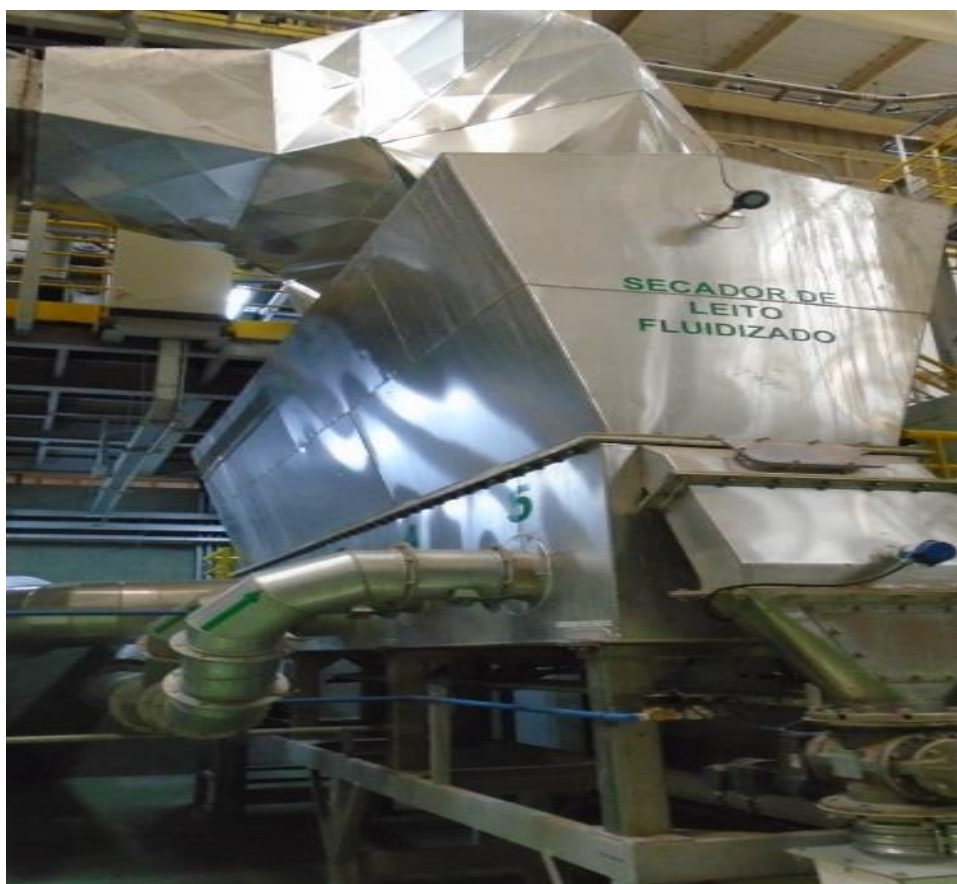
Figura 4.14 - Secador de leito fluidizado, constituído por cinco câmaras (Autor, 2020).
