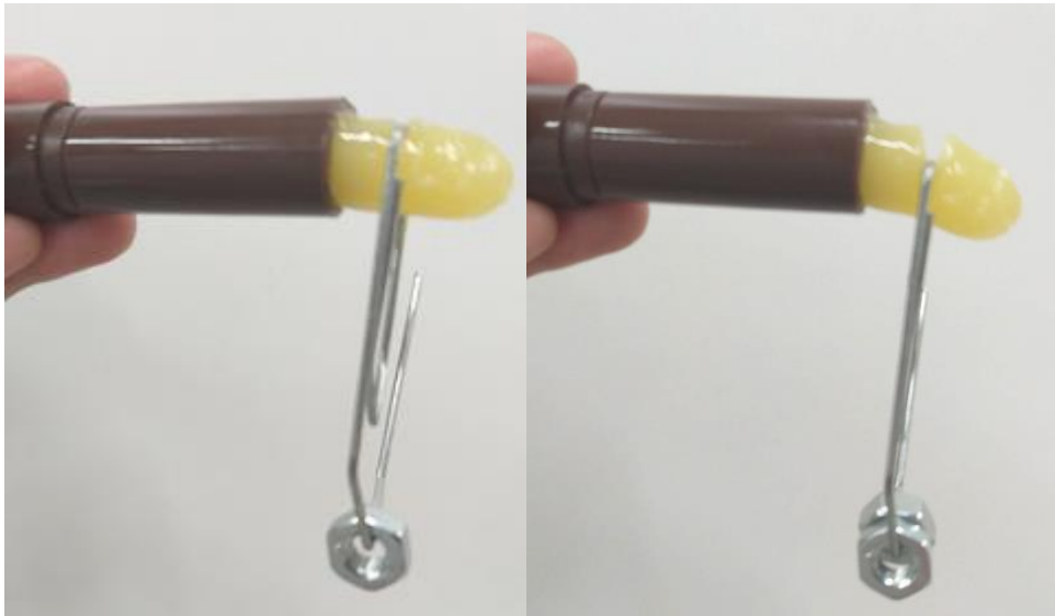
Figura 8: Aparato utilizado para a determinação do ponto de quebra das bases de batom. Fonte: Arquivo pessoal do autor.
