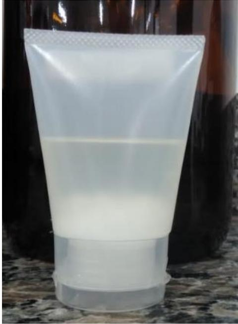
Figura 6: Xampu manipulado de uso veterinário, após 20 dias de acondicionamento em estufa à temperatura de 40C com o aspecto de separação de fases.
