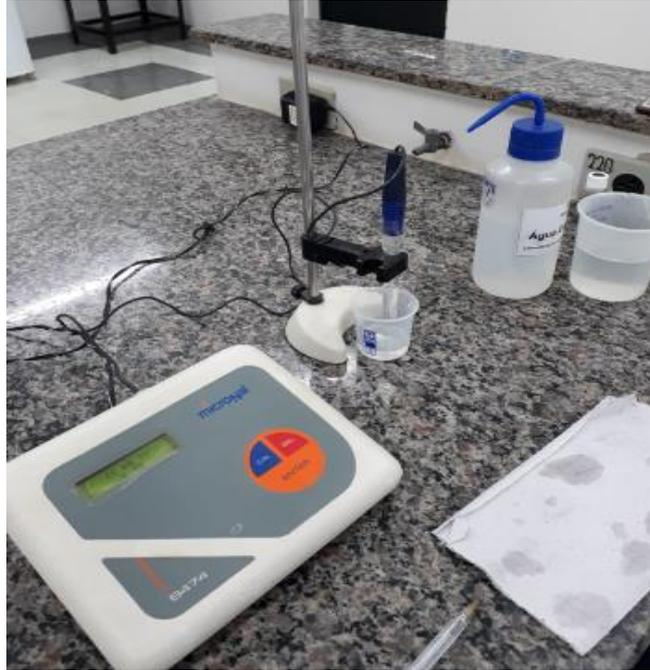
Figura 3: Peagâmetro utilizado na realização das leituras do valor de pH.
