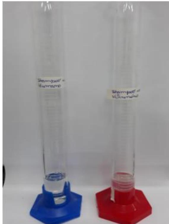
Figura 11: Amostra dos xampus manipulados após agitação e repouso de cinco minutos com pouca formação de espuma e nenhuma estabilidade de espuma.
