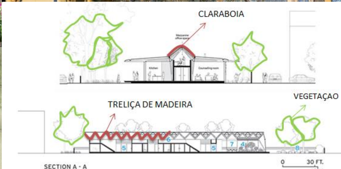
Figura 20- Esquema de elementos construtivos e paisagístico do MAGGIE'S CENTRE Fonte- https://www.archdaily.com.br/ e análise elaborado pela autora
