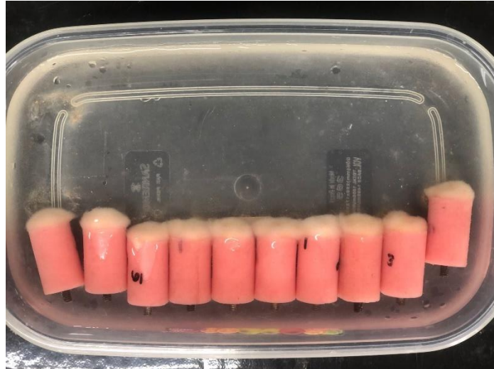
Figura 6. Conjunto espécime e adesivo submerso em água destilada após o período pré-determinado na estufa
