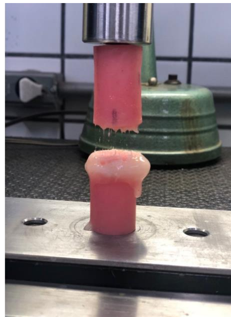
Figura 7. Ensaio da força adesiva em Máquina de Ensaio Universais
