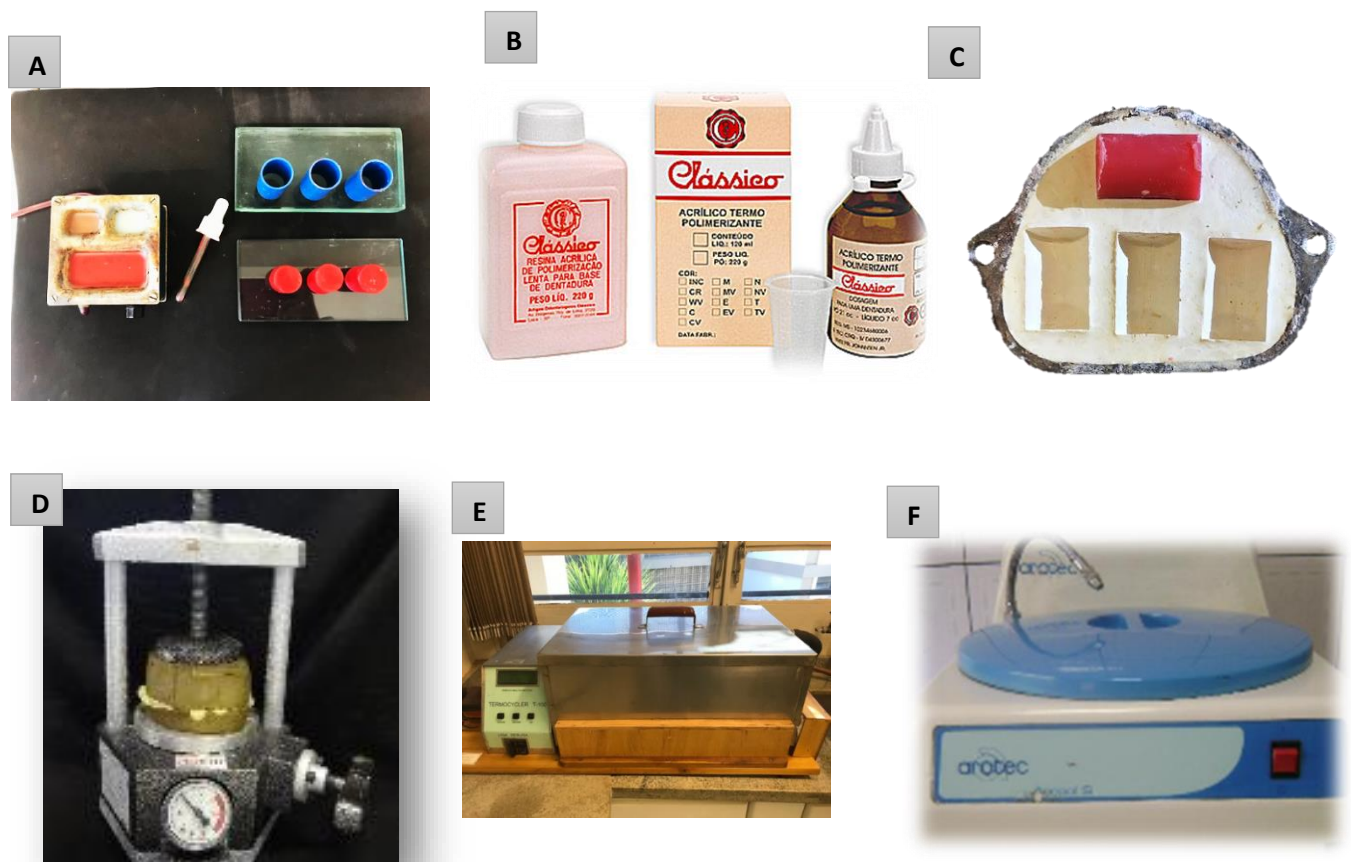
Figura 2. Confeção dos espécimes em Resina Acrílica. A- Preparação dos moldes em cera, B- Resina Acrílica Utilizada C- Moldes dos espécimes, D- Prensagem em prensa hidráulica, E- Termocicladora elétrica, F- Acabamento e polimento dos espécimes.
