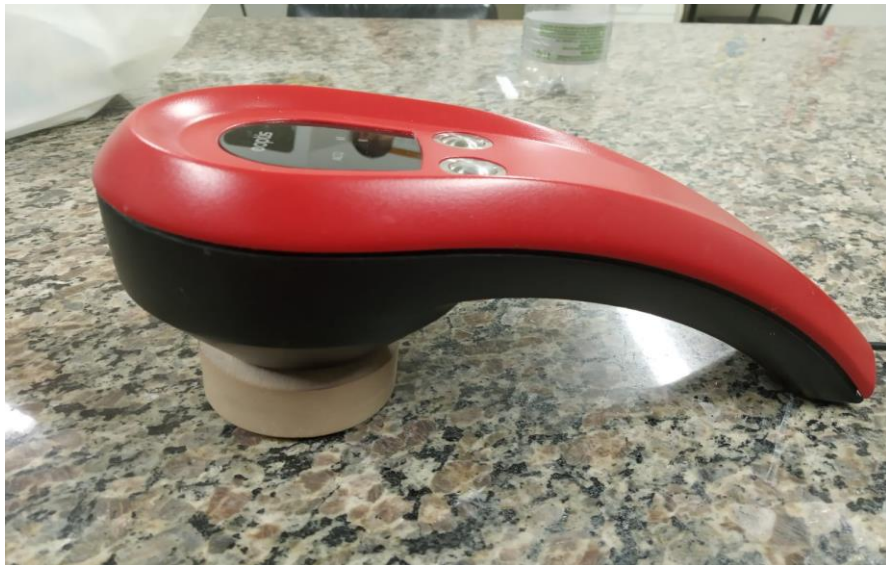
Figura 11: Técnica para aferir as coordenadas CIE L*a*b* Fonte: Autor
