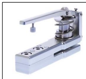
Figura 15: Cortador manual de eletrodo da marca Hohsen Corp. (Japan).
