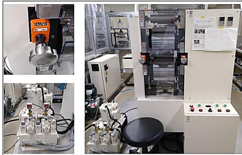
Figura 14: Prensa do tipo calandra, de cilindro duplo.
