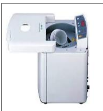
Figura 11: Misturador centrífugo, da marca: Thinky (USA), modelo: AR-100.
