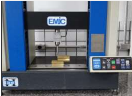
Figura 4 – Máquina de ensaios mecânicos EMIC DL 3000®. Acervo pessoal
