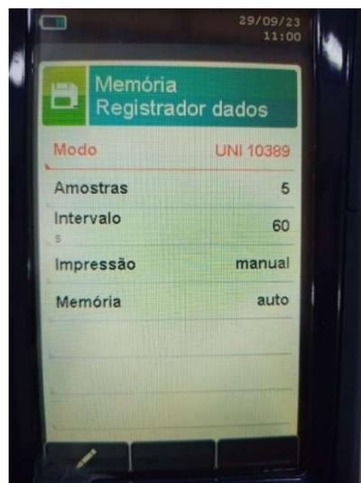
Figura 3- 11 – Modo de leitura utilizado na amostragem com o ECIL Chemist.
