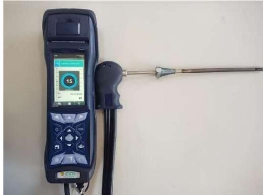
Figura 3- 7 – Analisador de gases de combustão ECIL Chemist 606 HC.
