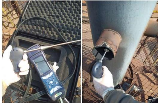
Figura 3- 10 – Coleta de amostra com equipamento ECIL Chemist 606.
