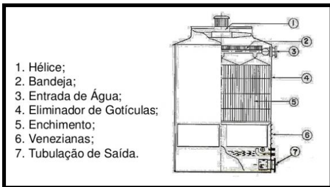
Figura 8 - Partes da Torre de Resfriamento. Fonte: Lima Junior, 2011.
