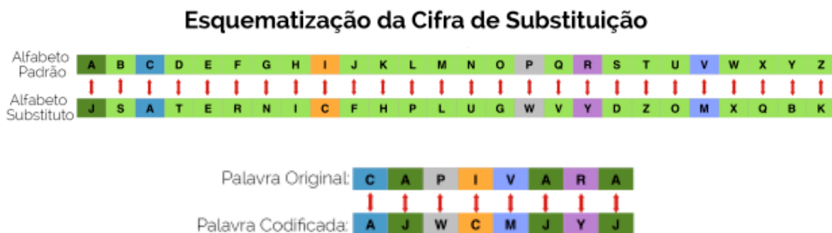
Figura 2 – Esquemática da Cifra de Substituição
