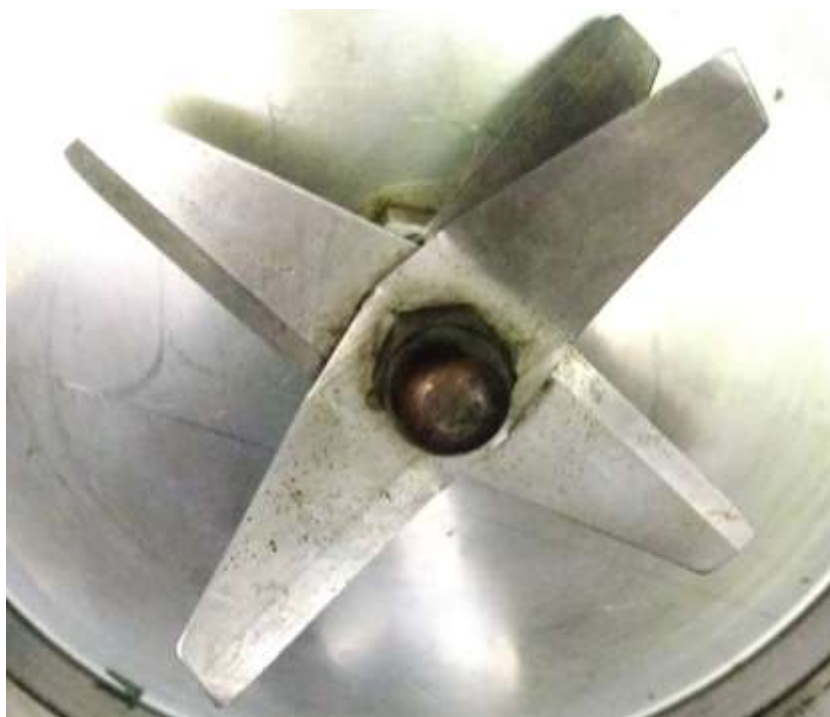
FIGURA 3.5 – Hélice do equipamento cutter. FONTE: Autor (2017).
