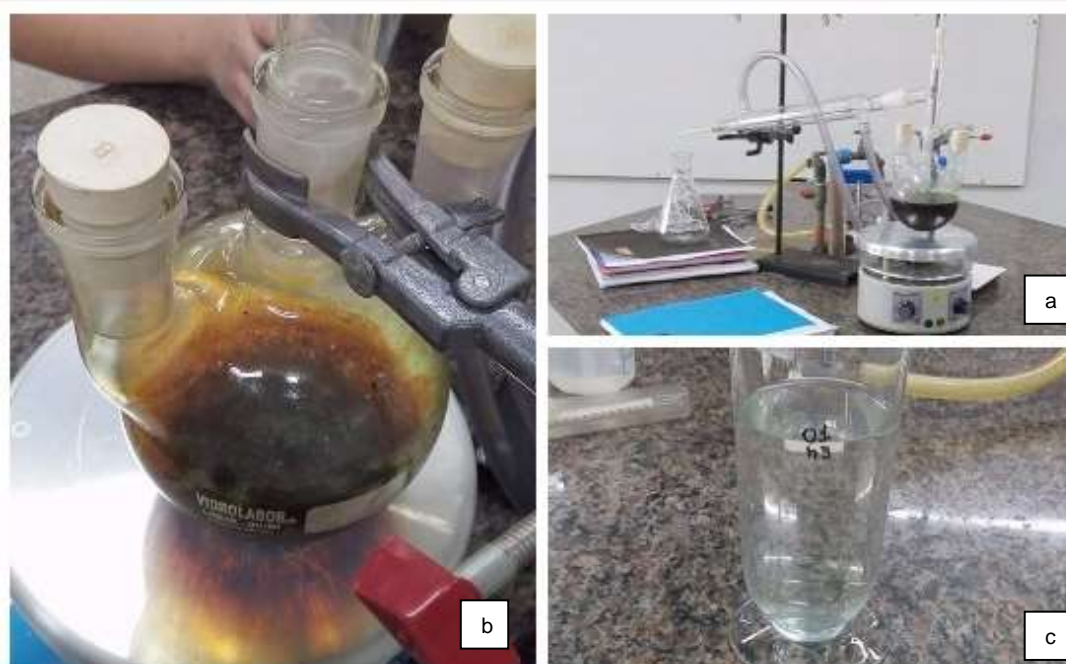
FIGURA 4.7 – Quantificação do teor de água no destilado: (a) destilação do extrato etanólico da folha fresca de nim; (b) resíduo obtido após destilação do solvente do extrato etanólico de nim; (c) destilado contendo etanol e água.
