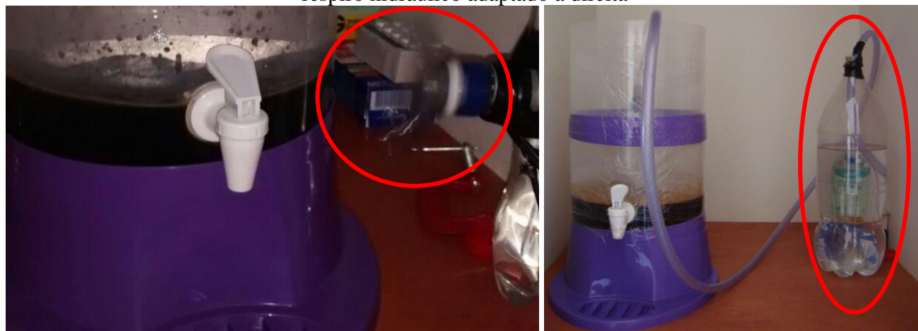
Figura 5: Filtro de fermentação com sistema de ventilação adaptado a esquerda e com sistema de respiro hidráulico adaptado a direita
