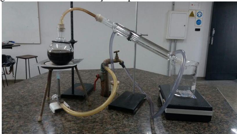
Figura 2: Processo de destilação simples utilizando condensador reto
