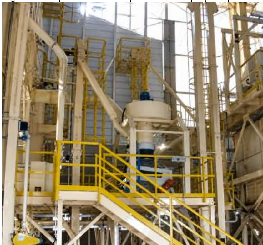
Figura 5 - Exemplo de sistema de limpeza do malte e aspiração do pó
