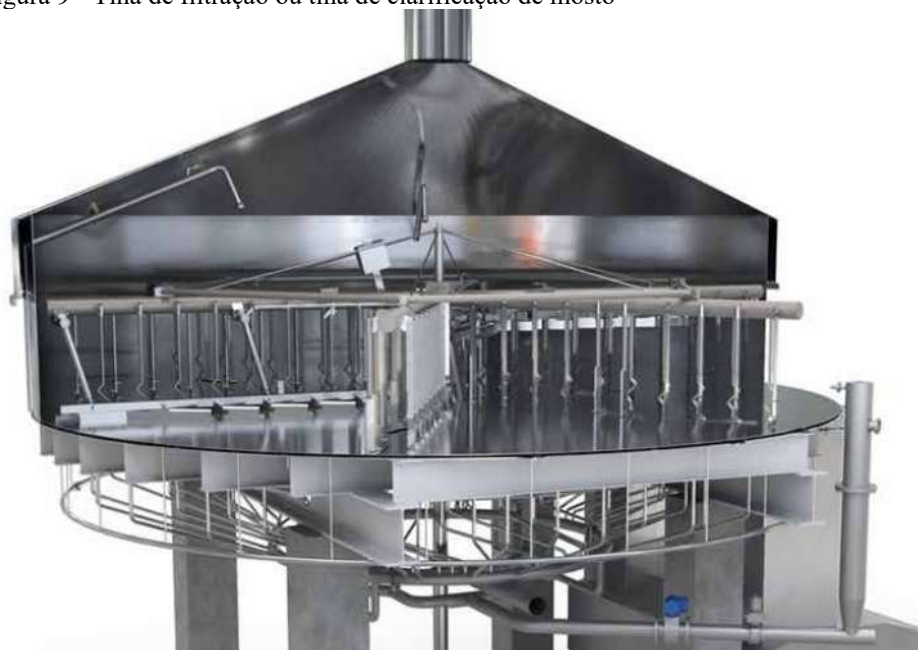
Figura 9 - Tina de filtração ou tina de clarificação de mosto
