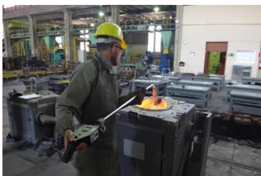
Controle de temperatura
