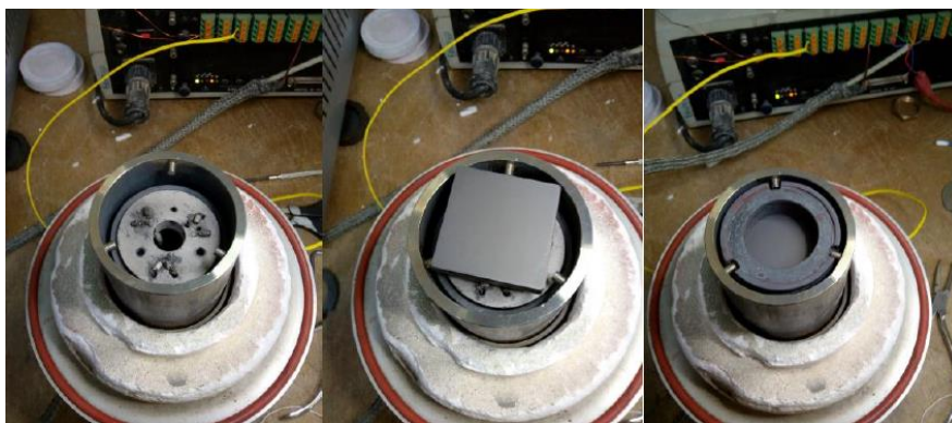
Figura 42 – Forno e sensores para análise de difusividade Fonte: Autor
