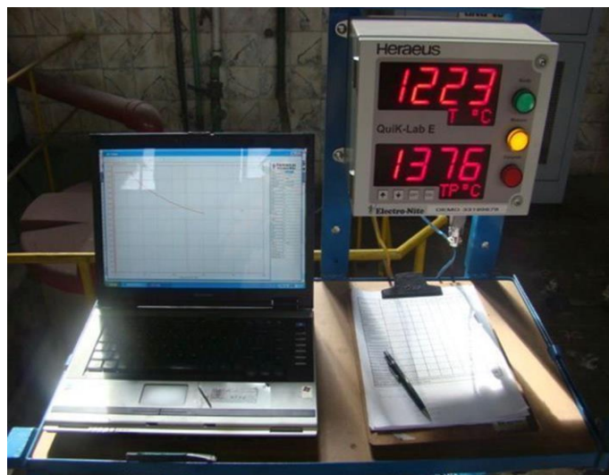
Figura 34 - Esquema e equipamento de análise térmica marca Heraeus ElectroNite Fonte: [Adaptado de] Relatório Senai Sistema FIEMG CETEC
