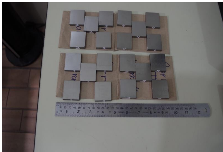
Figura 43 – Corpo de prova usinado para ensaio de difusividade Fonte: Autor
