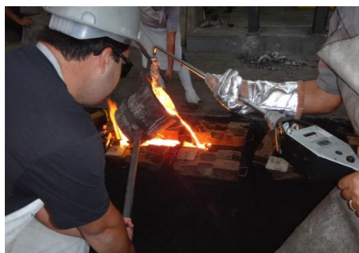
Vazamento da panela
