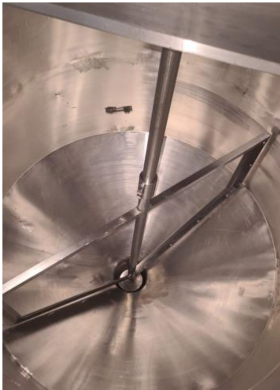
Figura 48: Nova pá de agitação móvel.
