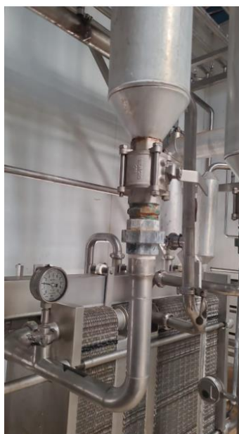
Figura 20: Sistema de resfriamento de creme na saída do pasteurizador com variação de 2 a 14 °C. Fonte: Do autor (2024).
