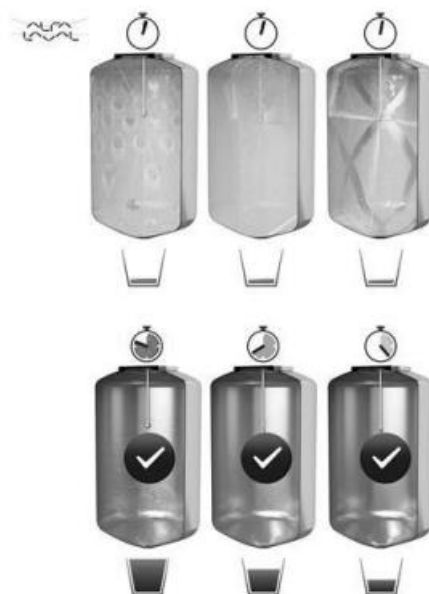
Figura 14 - Da esquerda para direita: Spray ball estático, pulverizador giratório, cabeça de jato rotativo. Fonte: ALFA LAVAL (2018).
